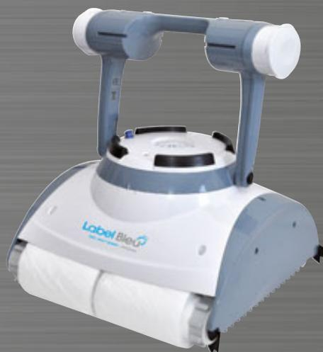
Le Pool Valet Senior fonctionne sur un cycle de 3 heures, afin de nettoyer le fond, les parois et la ligne d'eau de la piscine. C'est un appareil compact, qui se compose d'un moteur de traction et d'une pompe de filtration de 17 m<sup>3</sup>/h. Il s'adapte aux formes de piscines les plus complexes. **Le programmeur hebdomadaire permet de démarrer automatiquement le robot 1, 2 ou 3 fois sur un cycle d'une semaine.**
