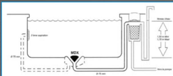
Muni du système de récupération automatique des débris (ADR), le PCC 2000 ne ressemble à aucun autre système de nettoyage. L'action de la bonde de fond active MDX permet d'absorber toutes les feuilles et autres débris qui seront ensuite canalisés et dirigés vers le piège à feuilles mural, installé sous la margelle. Facile d'accès, quelques secondes suffisent pour le retirer et le vider.
